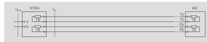
Am Ende des Busses in der IAE/UAE-Anschlußdose die Endwiderstände (2 x 100 Ω) einsetzen.
